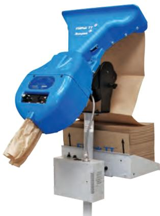
Permet au FillPak TT de couper et de définir des longueurs de papier. Outre l'ajout d'un mécanisme de découpe au FillPak TT, cette version améliorée permet également à l'opérateur de prédéfinir des longueurs de papier à l'aide du mode système de délivrance électronique (EDS). L'unité peut être réglée de manière à délivrer des longueurs comprises entre 30 cm et 3 mètres.
