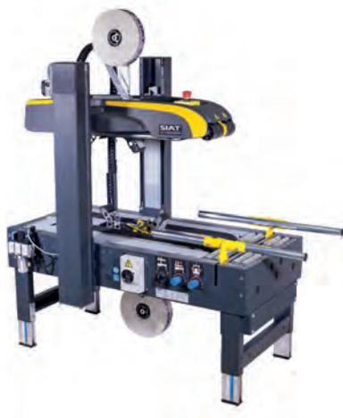
Fermeuse de caisses automatique avec table de centrage. Les boîtes doivent être introduites avec leurs rabats repliés. Deux systèmes de transport supérieurs et deux systèmes de transport inférieurs. Convient pour la fermeture en série de caisses. La hauteur et la largeur de la caisse sont réglées automatiquement.
