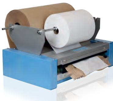
Geami WrapPak est la combinaison d'un papier kraft découpé breveté et d'un papier mousseline intercalé. Le convertisseur Geami WrapPak HV donne au papier découpé une structure alvéolaire 3D assurant un emballage unique.
