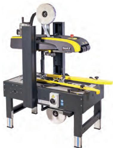
Fermeuse de caisses semi-automatique. Ferme le dessous et le dessus de la caisse. Deux systèmes de transport supérieurs et deux systèmes de transport inférieurs. Convient pour la fermeture en série de caisses. La hauteur et la largeur de la caisse sont réglées manuellement.
