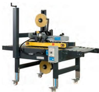
Fermeuse de caisses semi-automatique. Ferme le dessous et le dessus de la caisse. Le système de transport latéral est idéal pour fermer les caisses basses et de petites tailles. La hauteur et la largeur de la caisse sont réglées manuellement.
